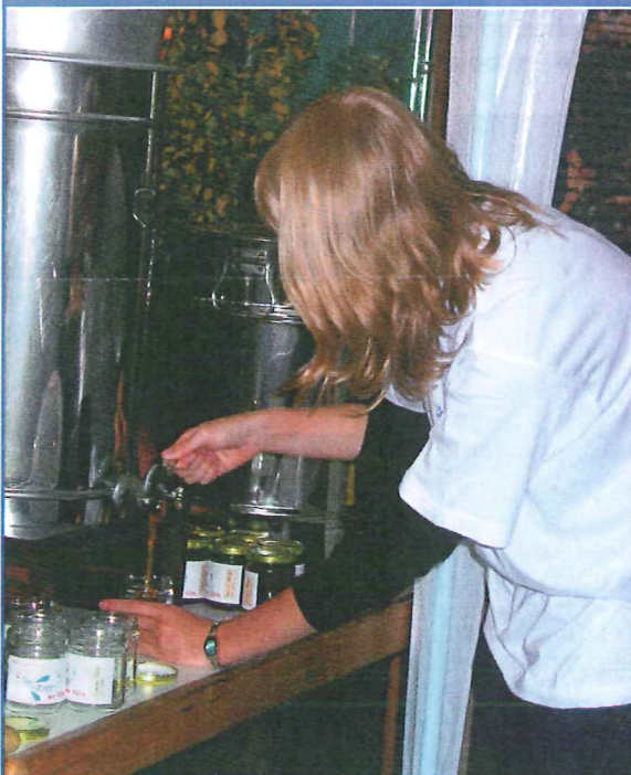
Le miel est ensuite filtré, puis placé dans un maturateur. Lorsqu'il est prêt, il est mis en boîte ou dans des bocaux.
